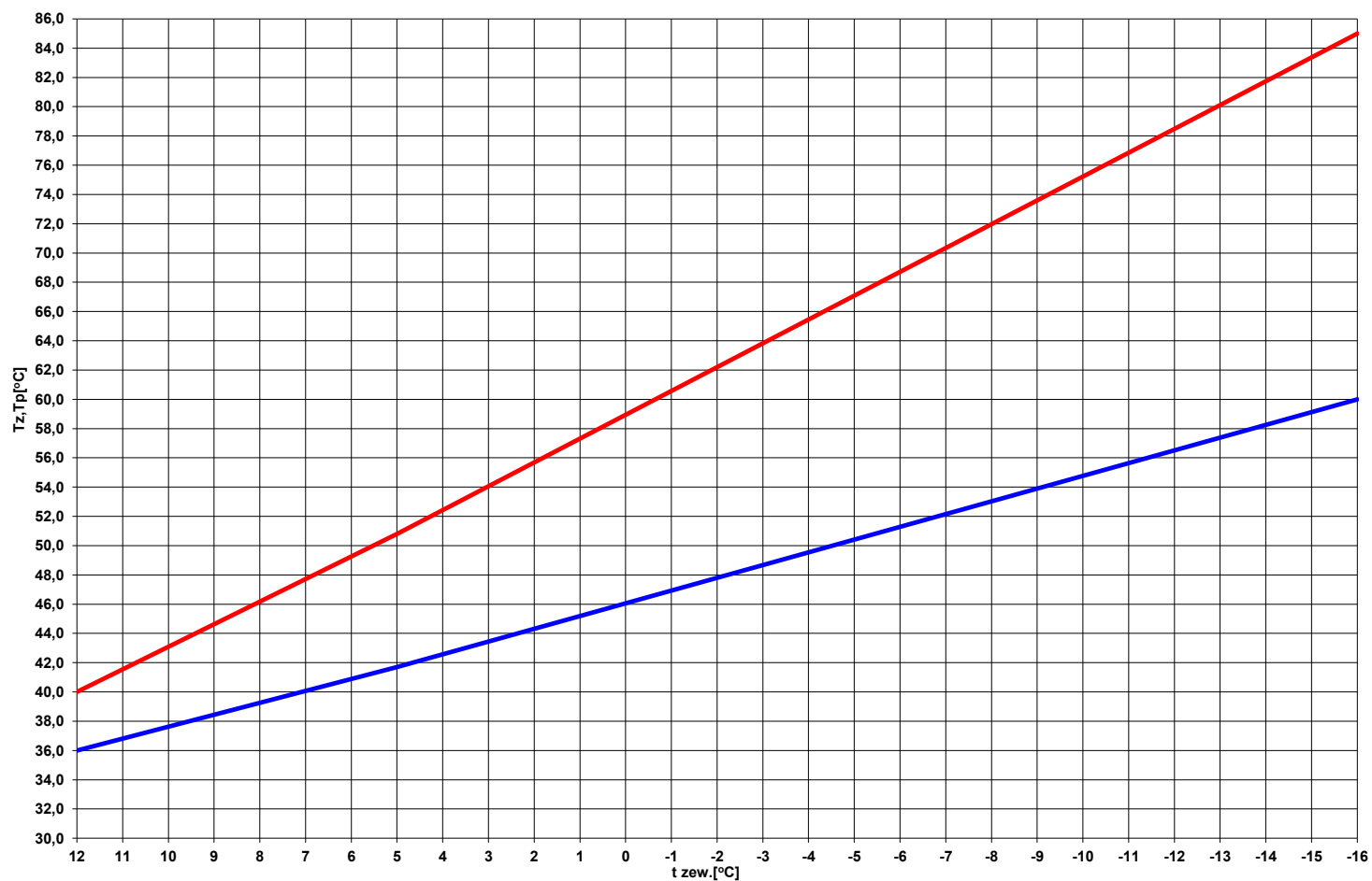
Wykres regulacyjny 85 / 60 °C dla sieci ciepłowniczej c.o. zasilanej z K-01 os. XX- lecia PRL w Kartuzach
